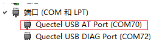
图 29: UC200T/EC200T Mini PCIe USB 端口
