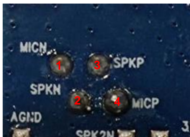
图 17：听筒接口（J502）引脚分配图
