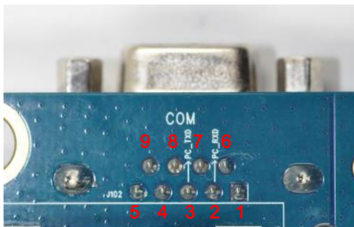
图 24：串口（J301）引脚分配图
