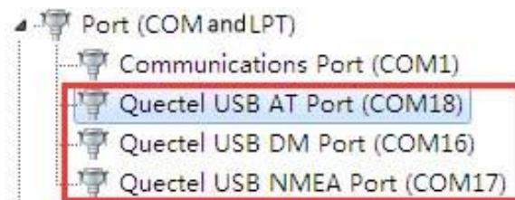
图 28: UC15/EC2x/EG2x-G/BGxx-M3 Mini PCIe USB 端口
