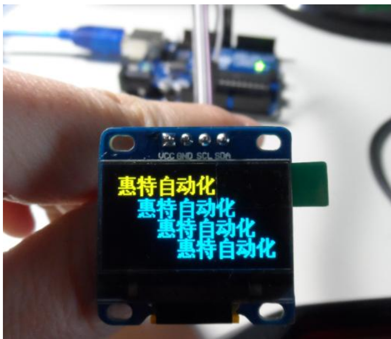
图 3-5 IIC 版在 Arduino 驱动下显示汉字（独家提供 IIC 版 Arduino 驱动，首次实现在 Arduino 系统中显示中文！）
